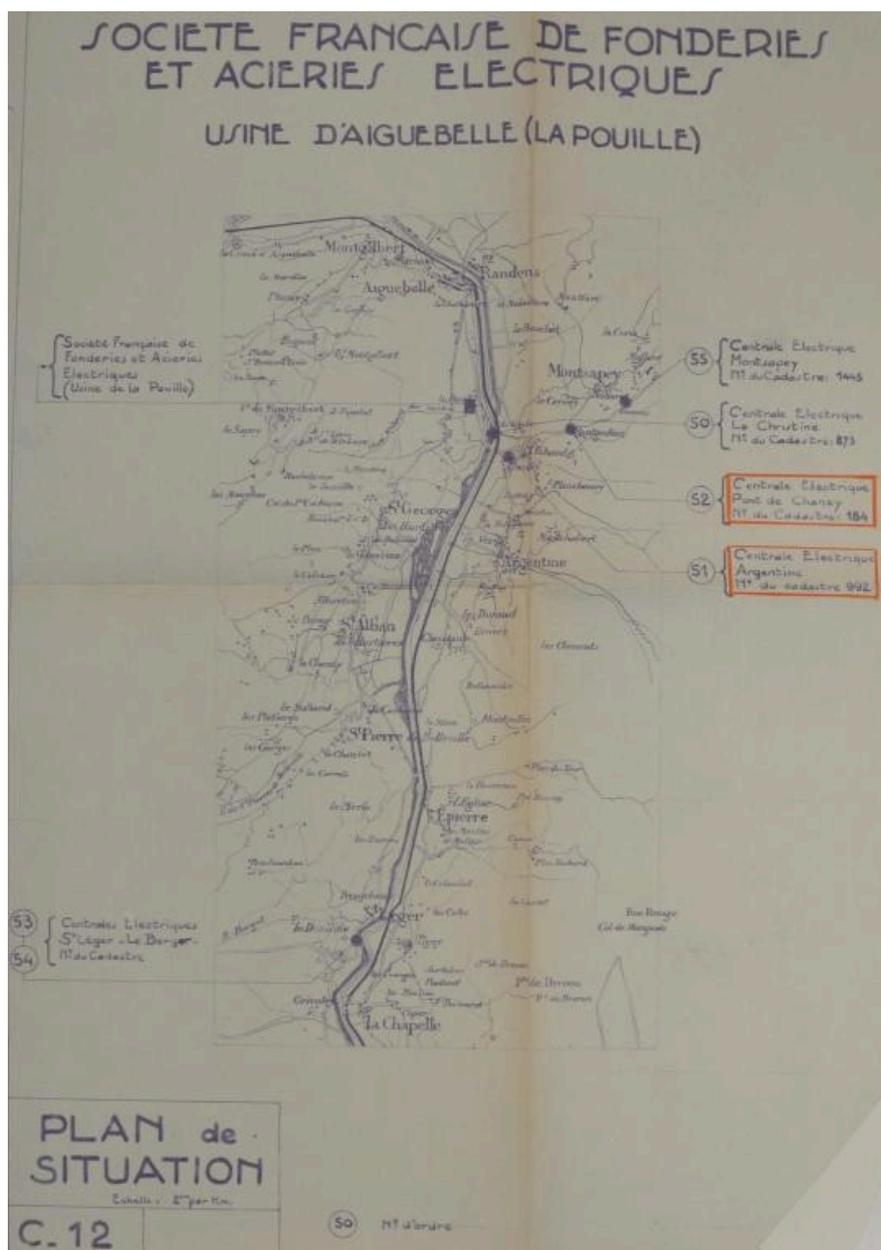
Carte faisant apparaître l'usine de la Pouille et les centrales hydroélectriques qui l'alimentent, 1945 (FR.AD073, 952W115).
