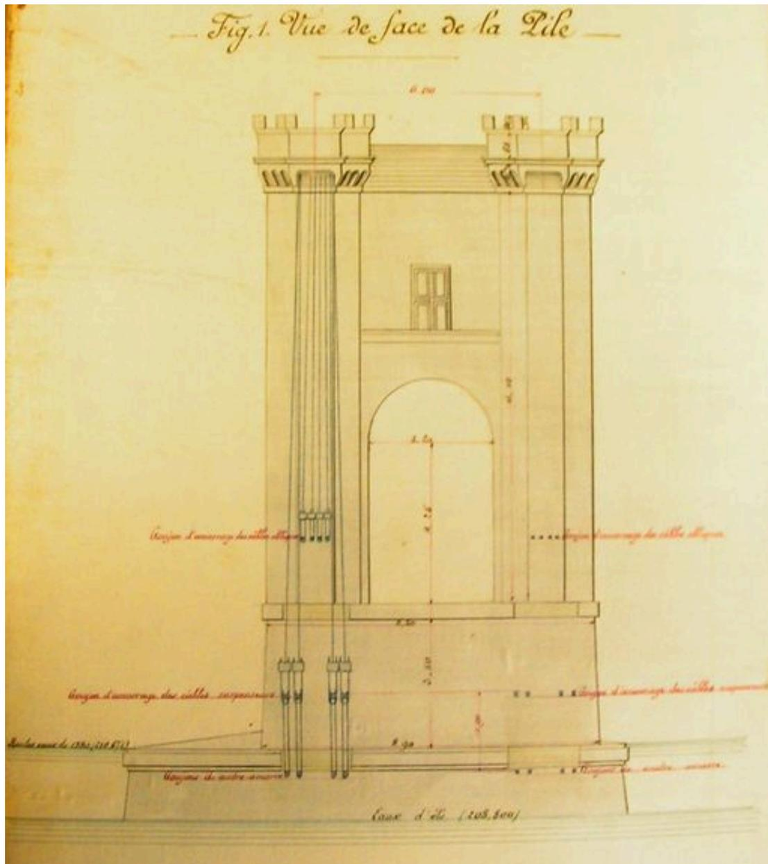
Assemblage des câbles à la pile. Fig 1 : Vue de face de la pile [ca 1894] (extr. de : AD Ain, 2S 538)
