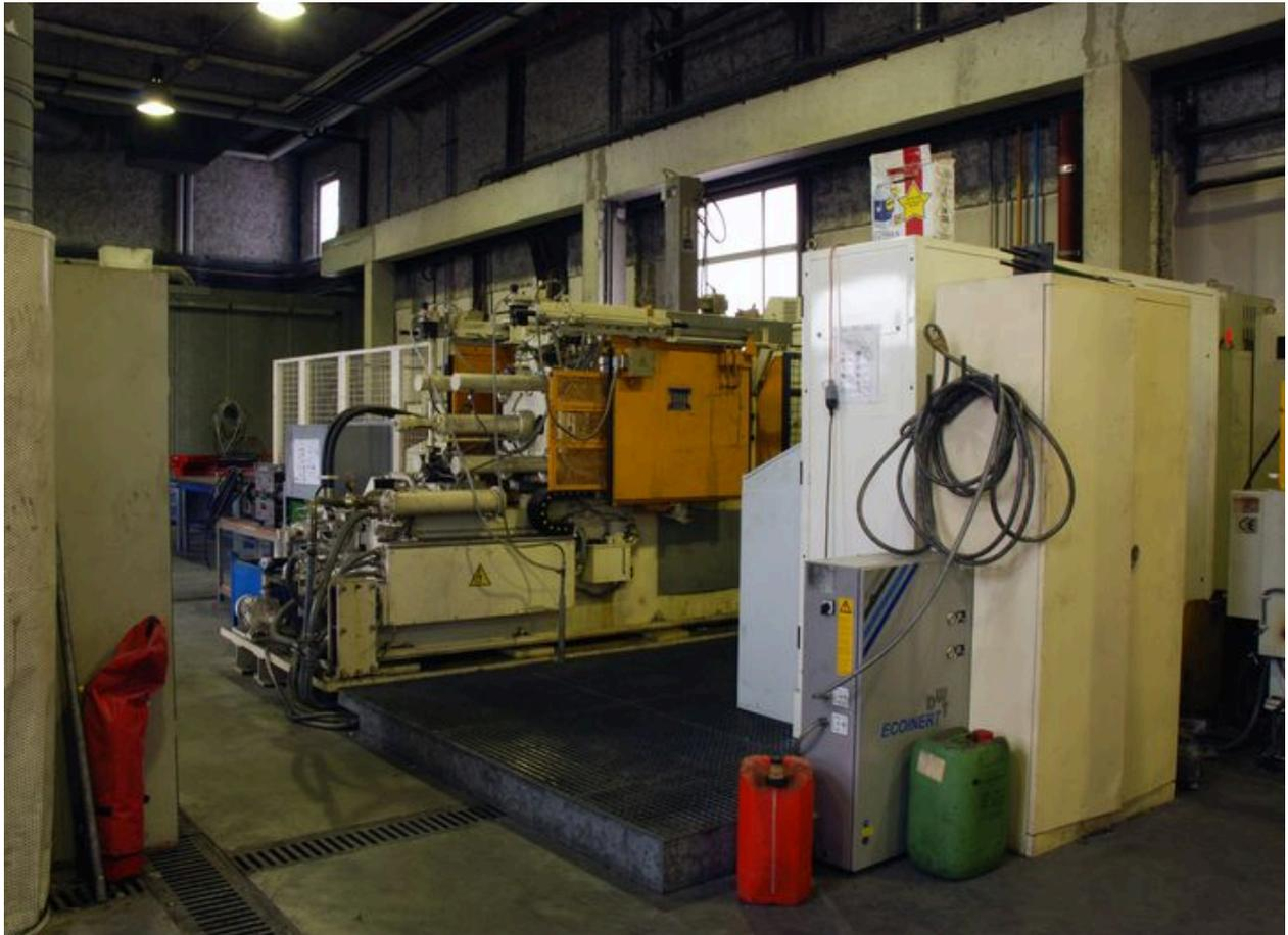
Machine à moulage sous pression IDRA PRESSE
