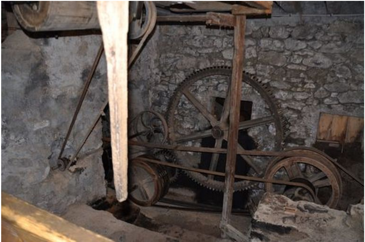
Détail du mécanisme de la battante de la scierie
