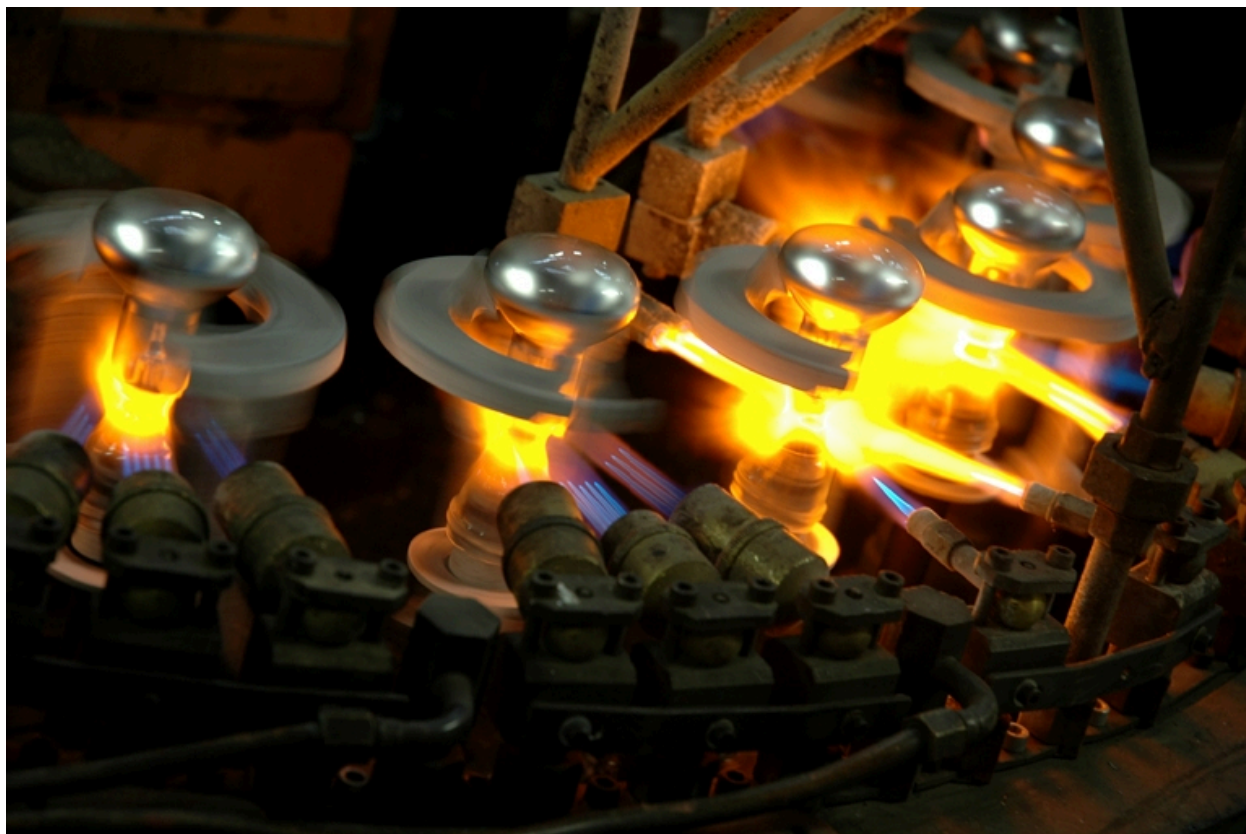
Séparation du pied et du ballon de l'ampoule, détail
