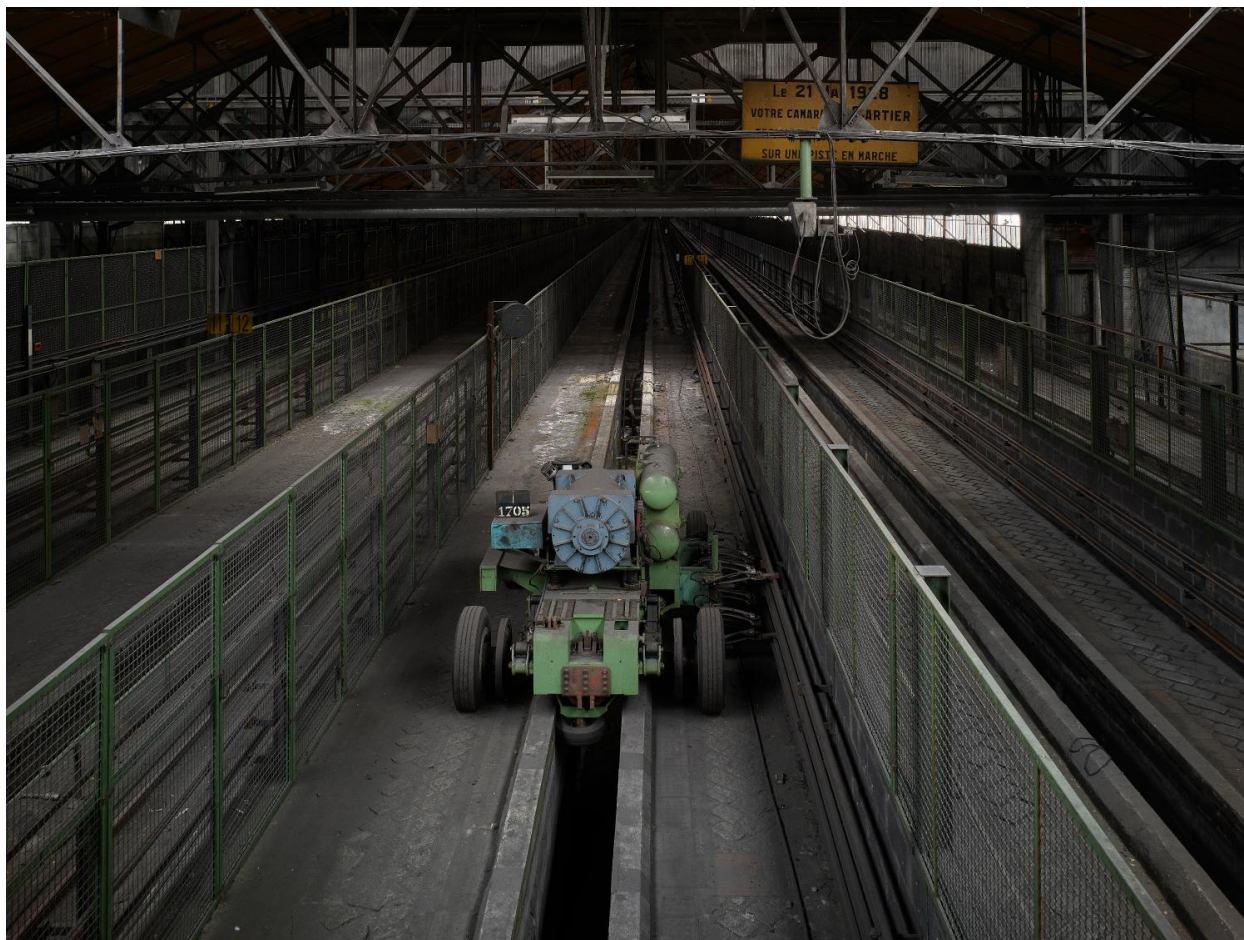
Vue intérieure de l'une des pistes d'essais (bâtiments F5) et d'un chariot utilisé pour tester les pneus.
