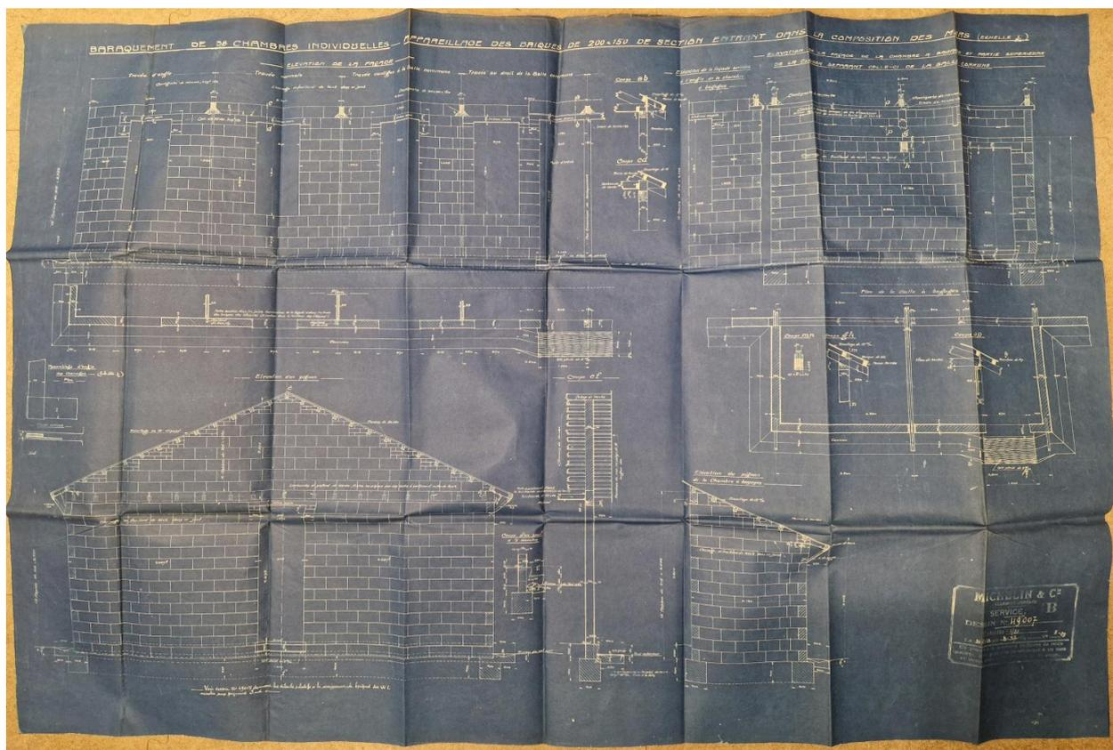
Projet de baraquements : appareillage des briques. Détail de plan et de coupes, élévation d'un pignon et autres détails d'élévation, bleu d'architecte, sans échelle et échelle 0,50 m/m, s.n., 21/08/1923. Archives municipales de Clermont-Ferrand, cote 16 A 450.
