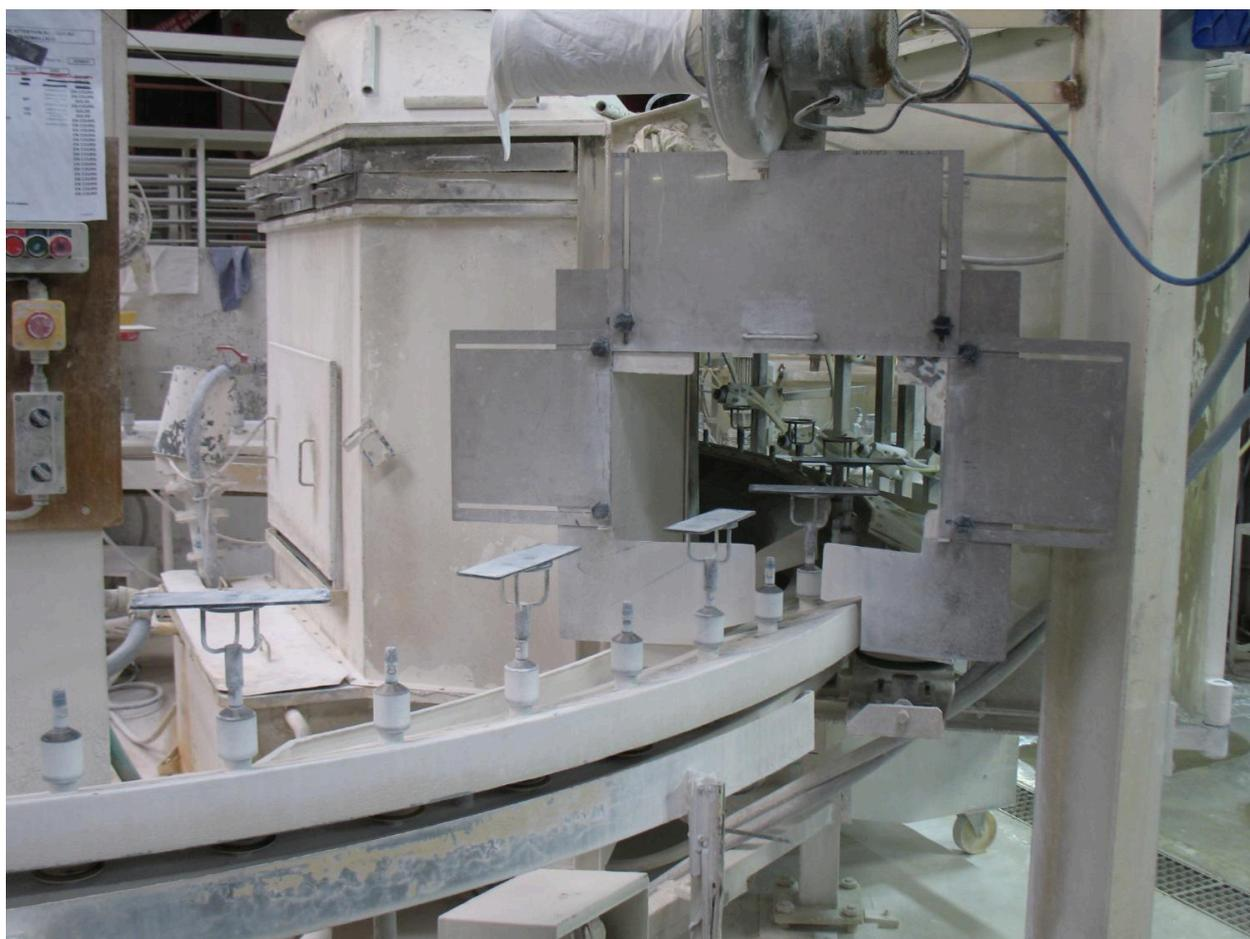
Emallage : machine carrousel vaporisation des pièces
