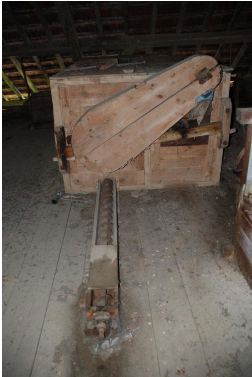
Vue intérieure du comble, partie nord : blutoir, vis sans fin.
