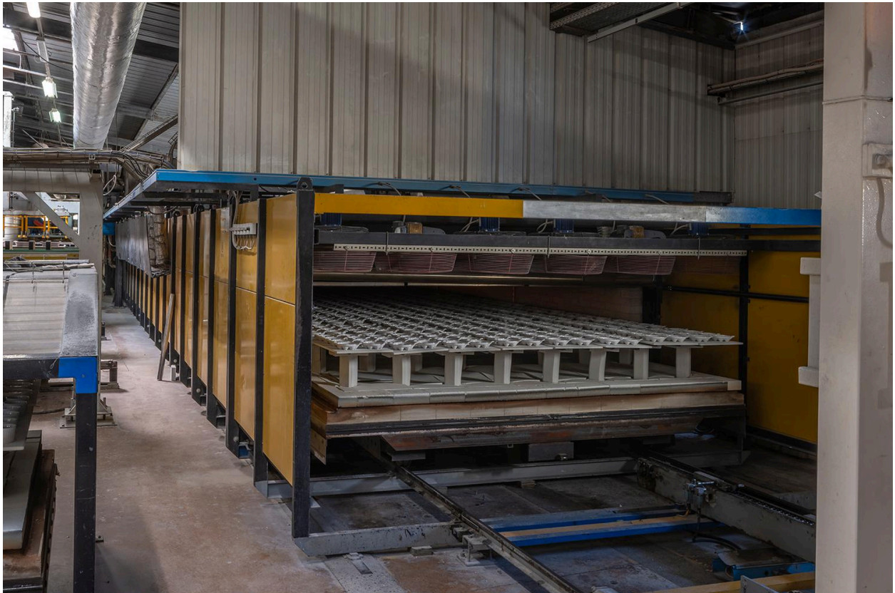
Séchoir four tunnel de l'usine de céramique culinaire "Revol porcelaine"
