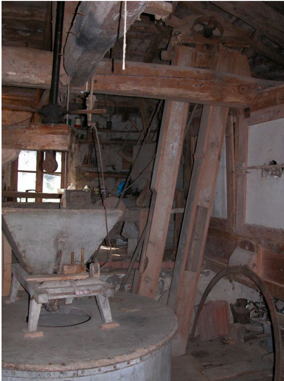
Rez-de-chaussée surélevé, détail de la trémie des meules.
