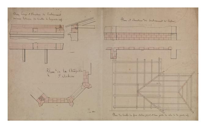
Plan, coupe et élévation de l'exhaussement des murs latéraux du comble de la grande nef. Plan de la chapelle Saint-Aubrin (..)Dessin : encre (plume et lavis coloré) sur papier ; traces d'esquisses au crayon. Sans éch. 29,6x50 cm. Vers 1833 [date ajout
