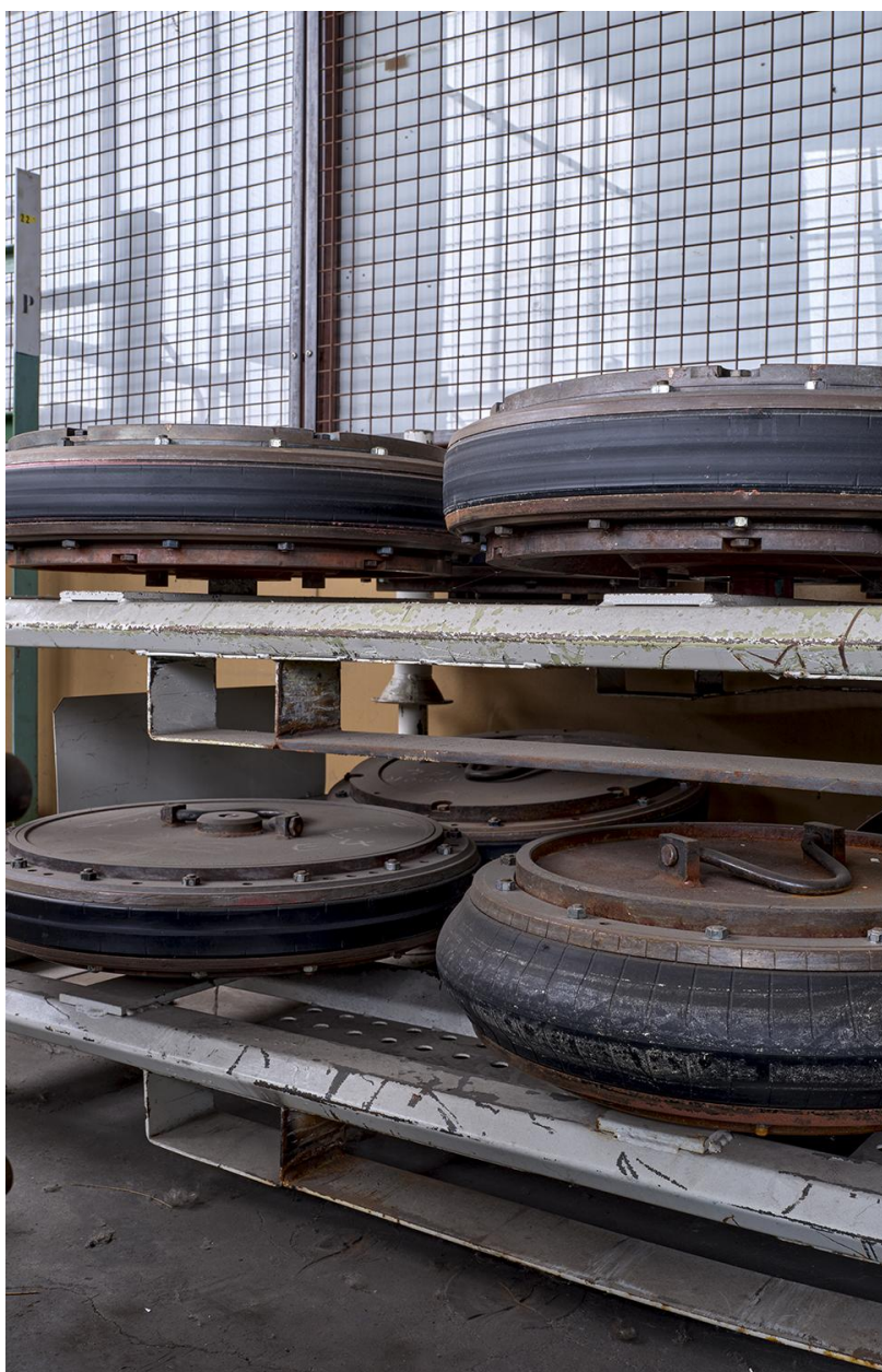
Atelier V22 : moules pour pneumatiques stockés dans l'atelier.
