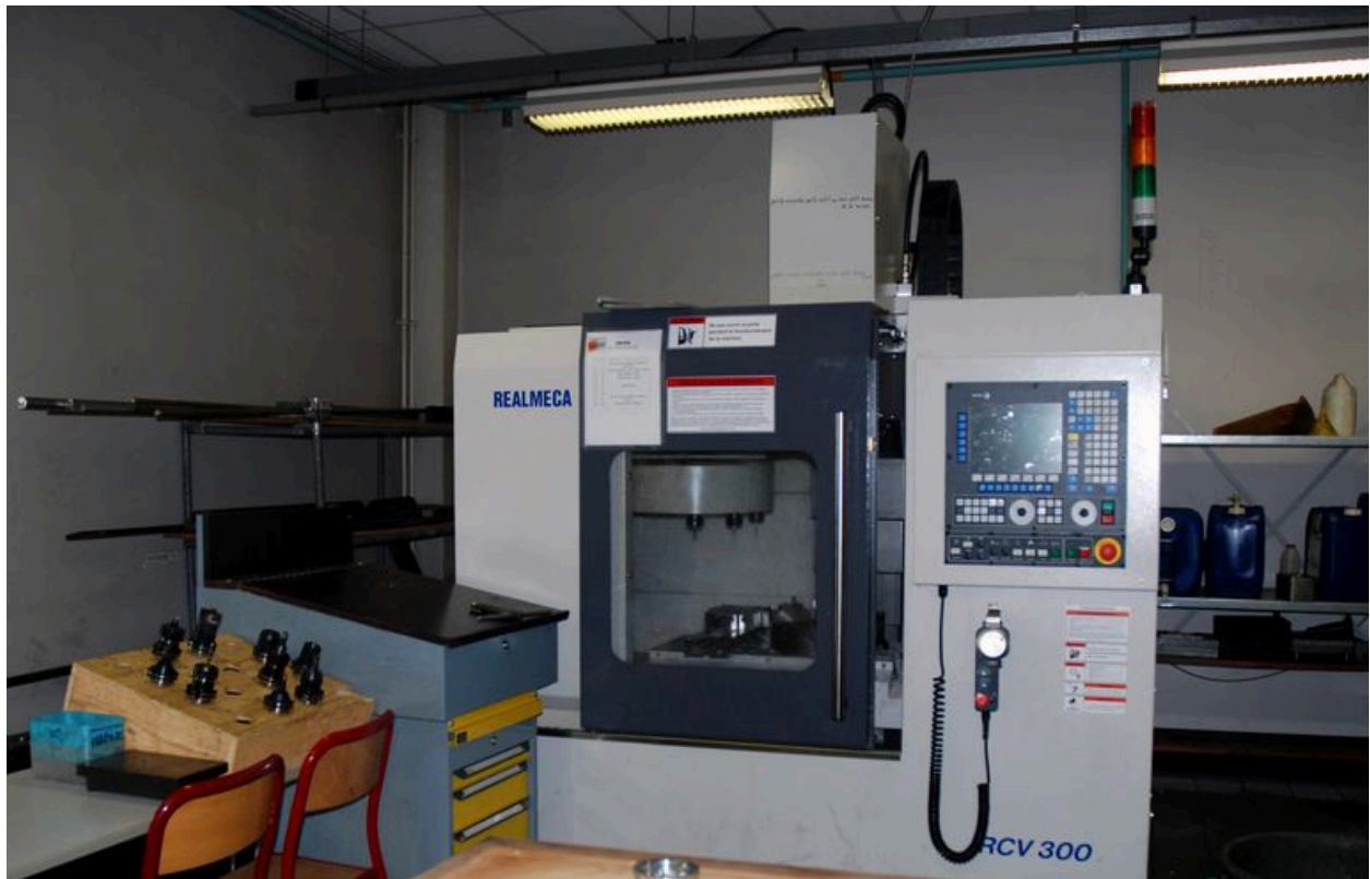
Atelier outillage : centre d'usinage REALMECA RCV300
