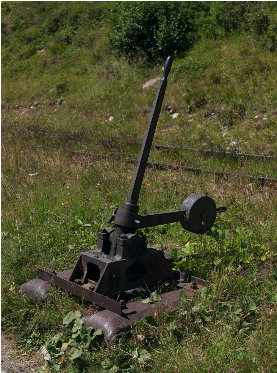
Element d'aiguillage de la ligne TMB, matériel fabriqué par la société Jules Weitz à Lyon.
