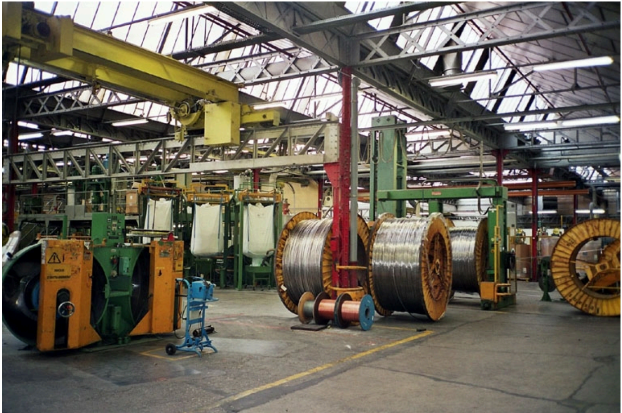
Ligne d'isolation EO1
