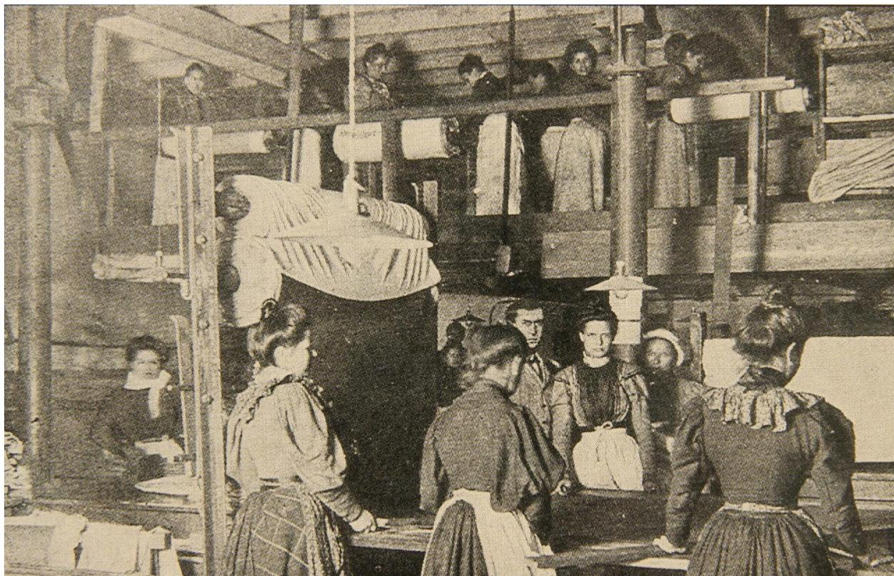
Intérieur d'un atelier des usines Michelin : le découpage des bandes de toile des enveloppes de pneumatiques.
