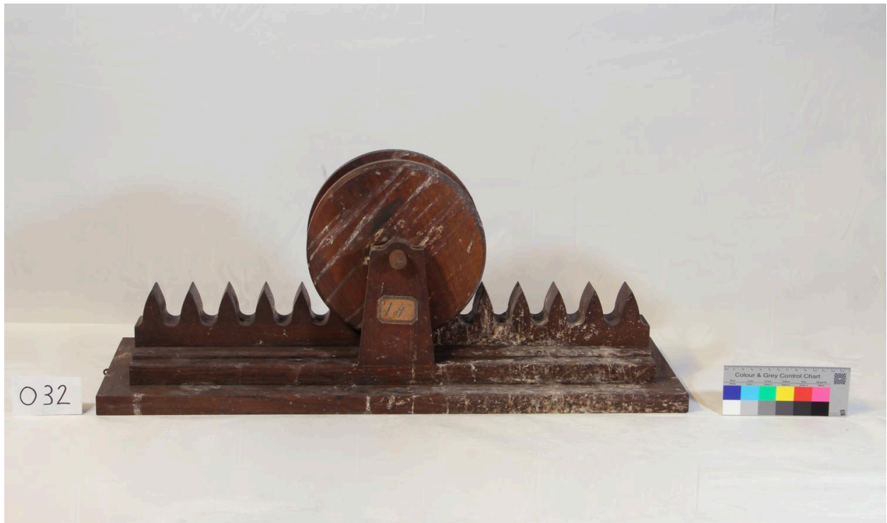
Modèle d'engrenage à crémaillère à lanterne
