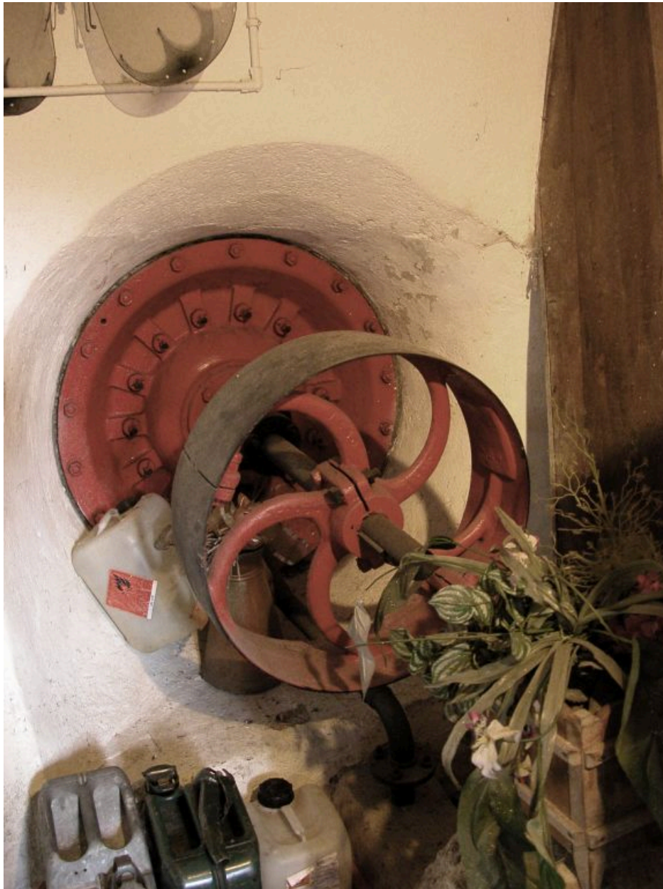
Détail des axes et poulies d'entraînement.
