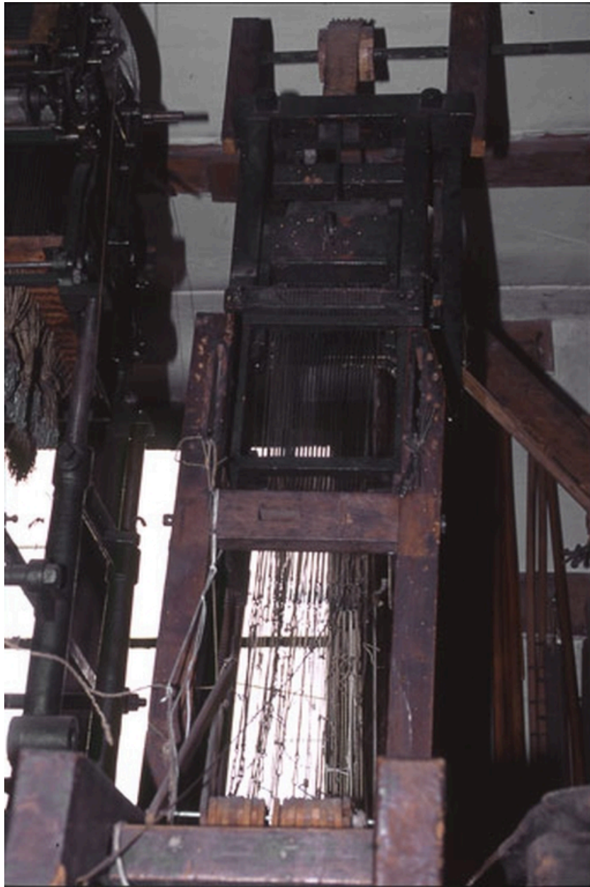
Mécanique d'armure du métier étroit (85 cm de tissu)
