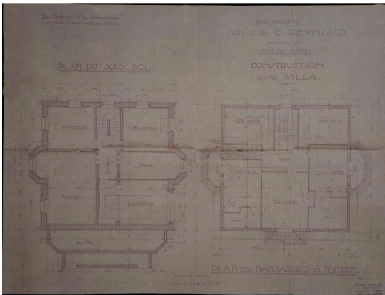
Plans du sous-sol et du comble à surcroît
