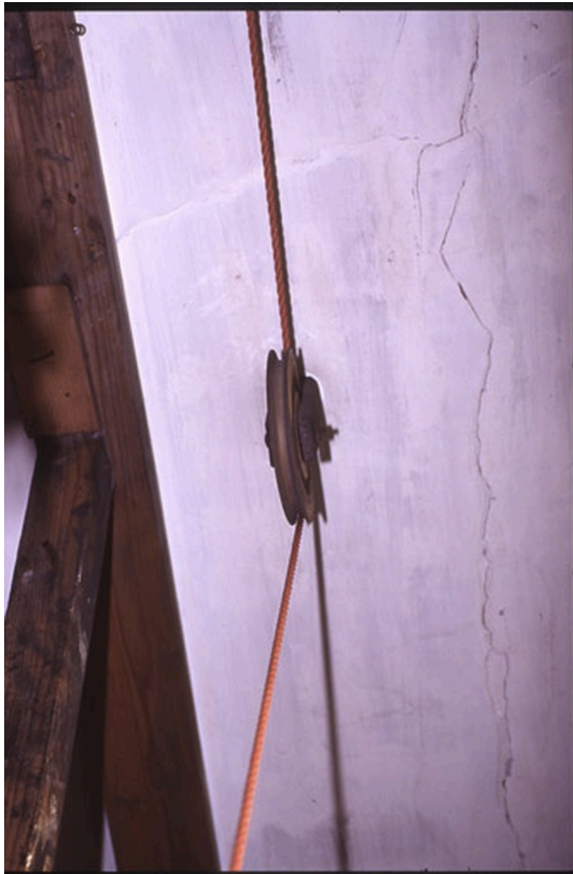
Pouli du compensateur du savoyard (tension rouleau magasin)
