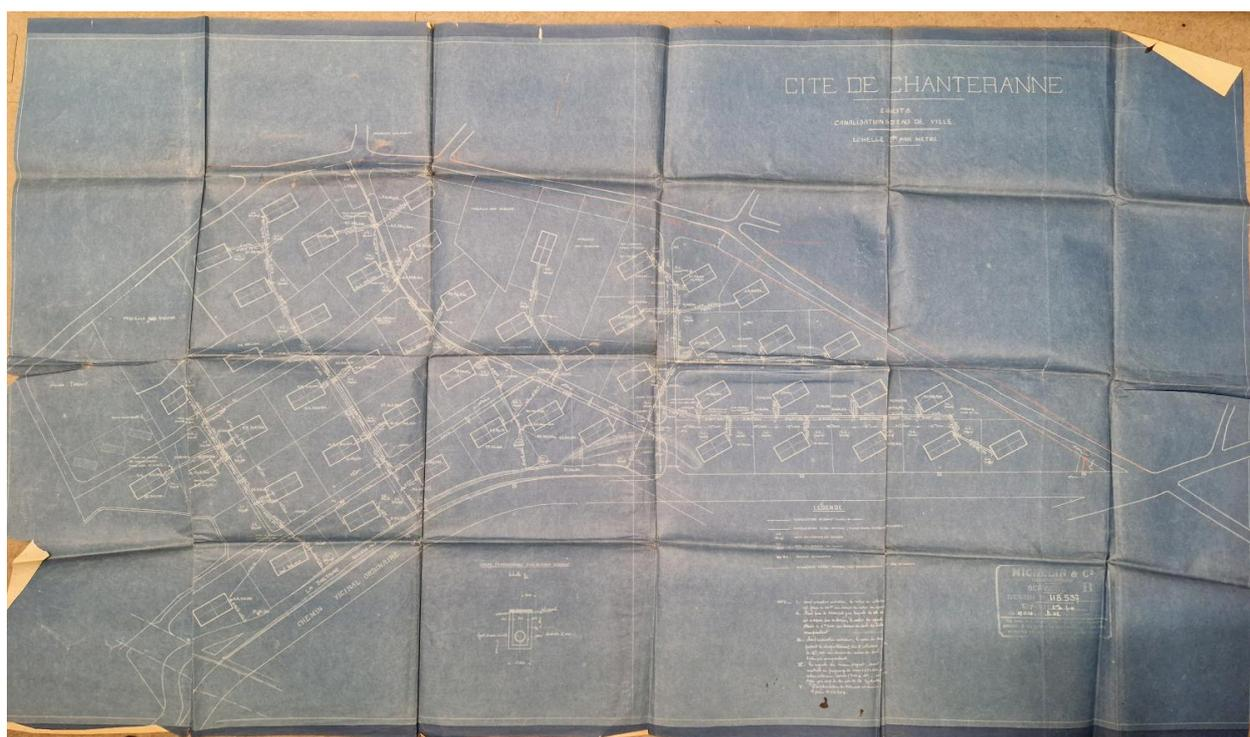
Projet d'implantation des maisons d'habitations de la cité : plan masse et tracé des égouts et canalisations, bleu d'architecte, échelle 0,002 m/m, s.n., 29/05/1923. Archives municipales de Clermont-Ferrand, cote 16 A 205.
