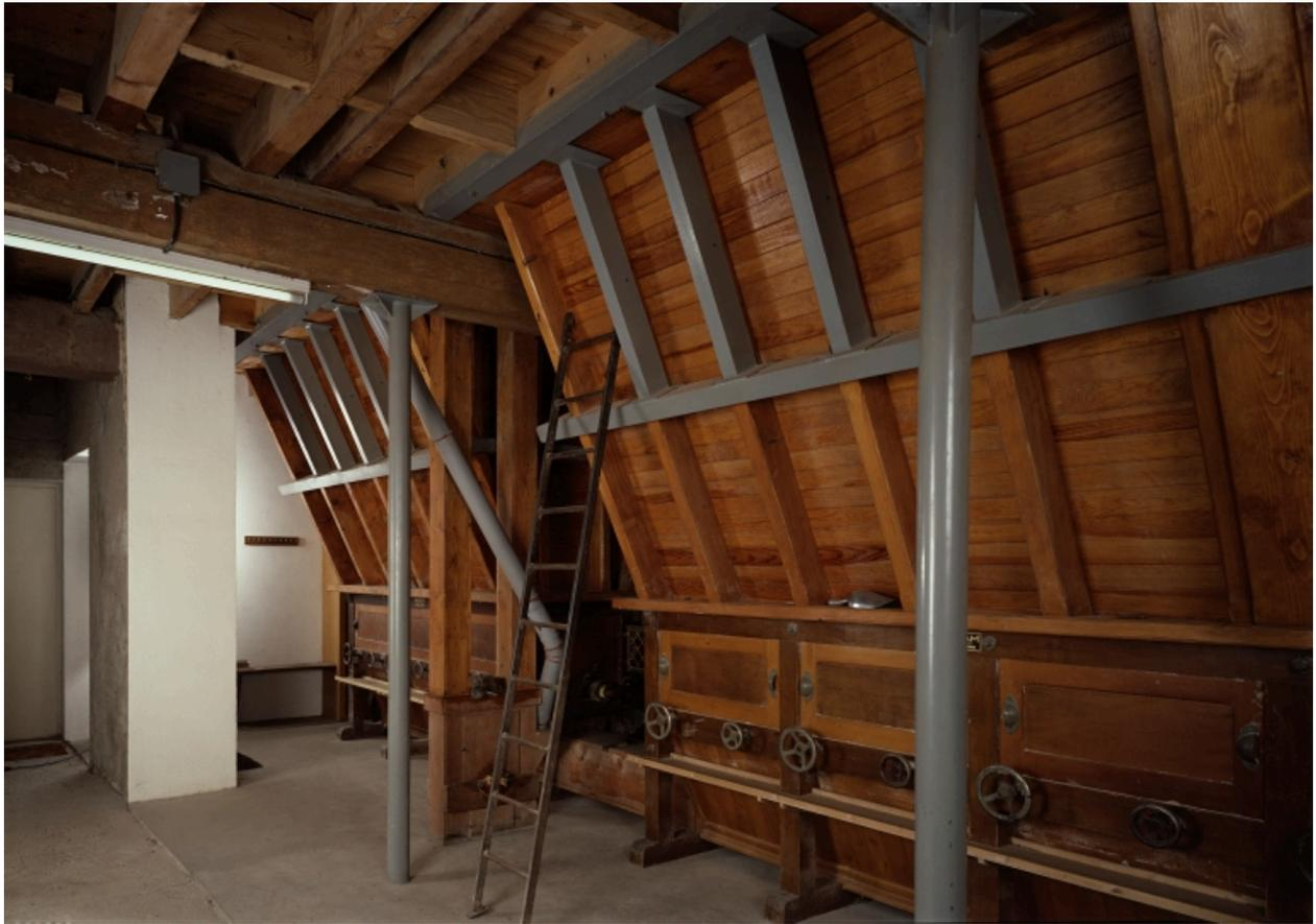
Etage de soubassement (sud-ouest) : élévateurs et trémies à mélangeurs.
