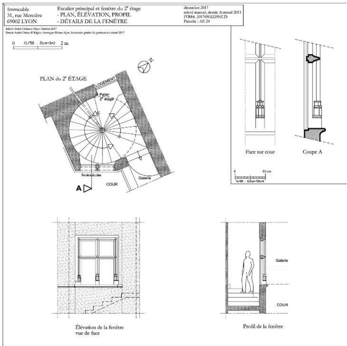
Plan de la deuxième volée de l'escalier. Coupe, profil et élévation de la fenêtre du deuxième étage de la cage d'escalier
