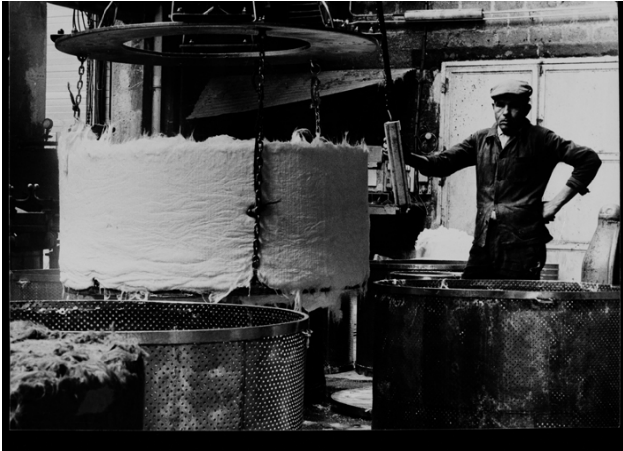
Sortie des matières 1ères teintes de l'autoclave (2 paires superposées)
