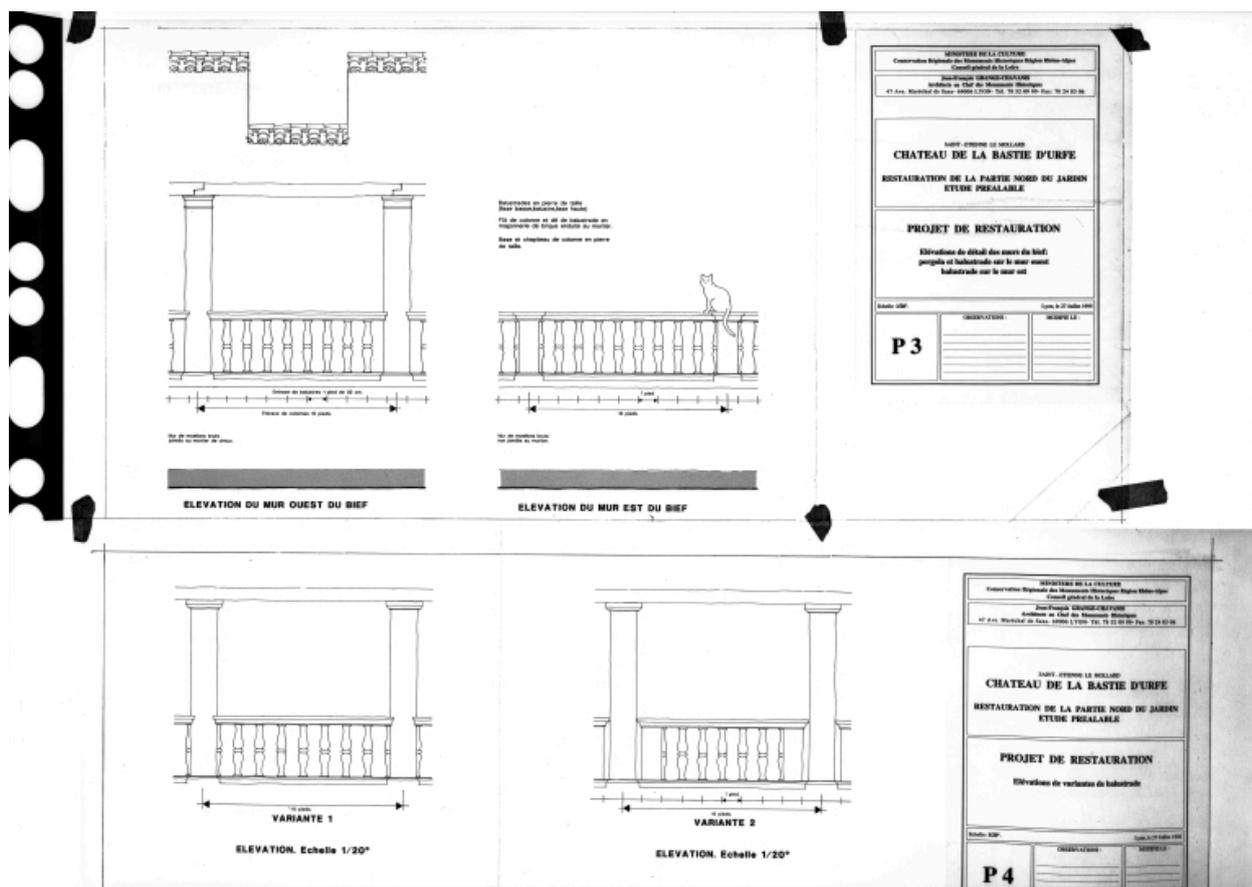
Projet de restauration de la partie nord du jardin (projet en 1995) : dessin 1 : élévations de détail du mur du canal ; portique et balustrade sur le mur ouest ; portique sur le mur est ; dessin 2 : variantes pour le portique.
