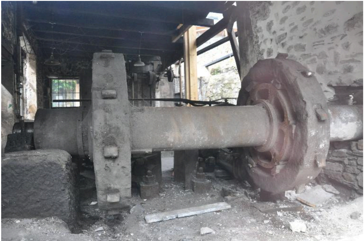
Arbre à cames actionnant les martinets, 2014.
