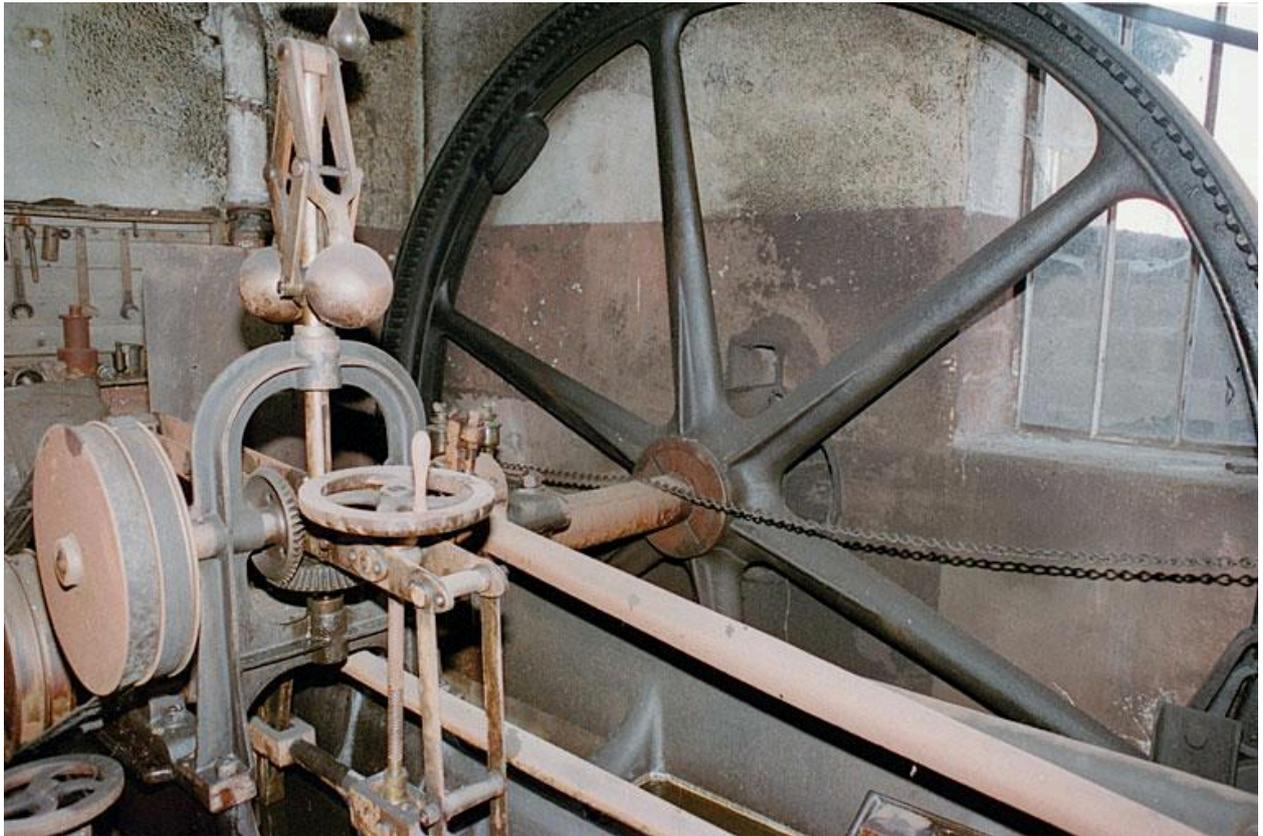
Détail volant et régulateur machine à vapeur
