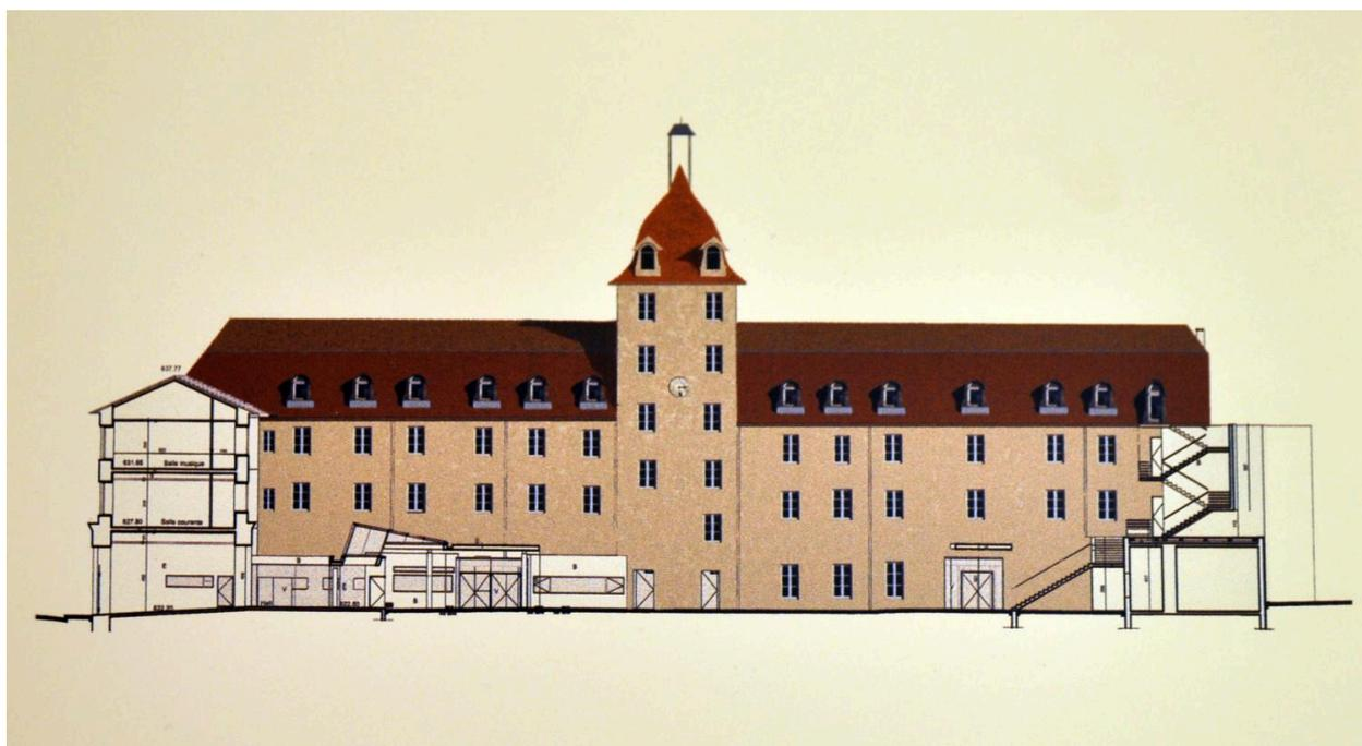
Projet de restructuration : élévation sur cour du bâtiment C et coupes des bâtiments A et D
