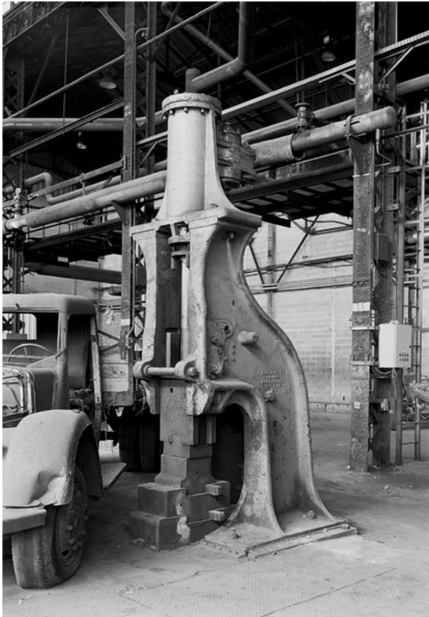
Forge : petit marteau pilon datant de 1950, la plaque métallique identifiante, B et S Massey-Limited Manchester-PATENT (n° 1039).
