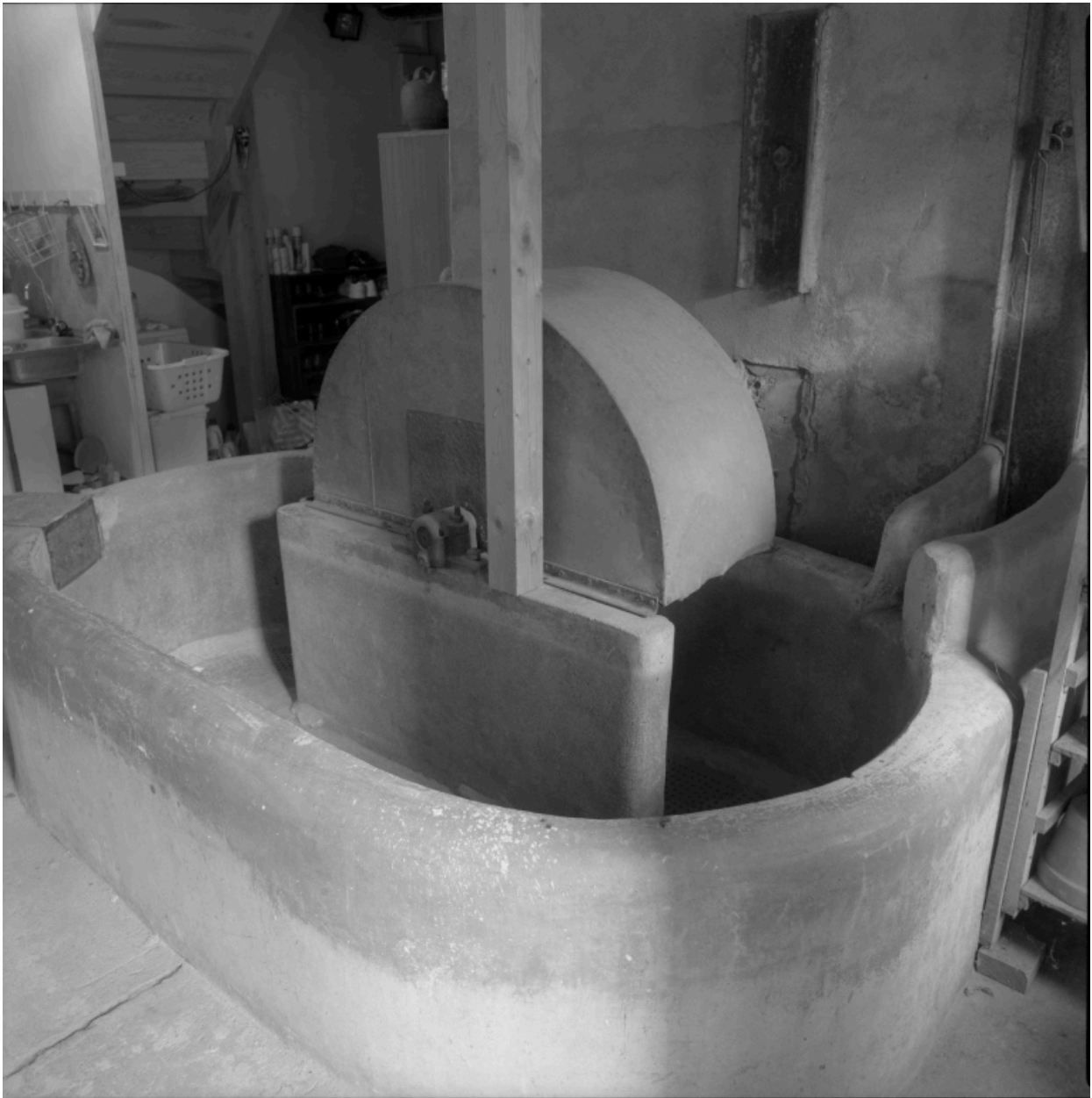
Vue d'ensemble d'un bac pour teinter et rincer la laine.
