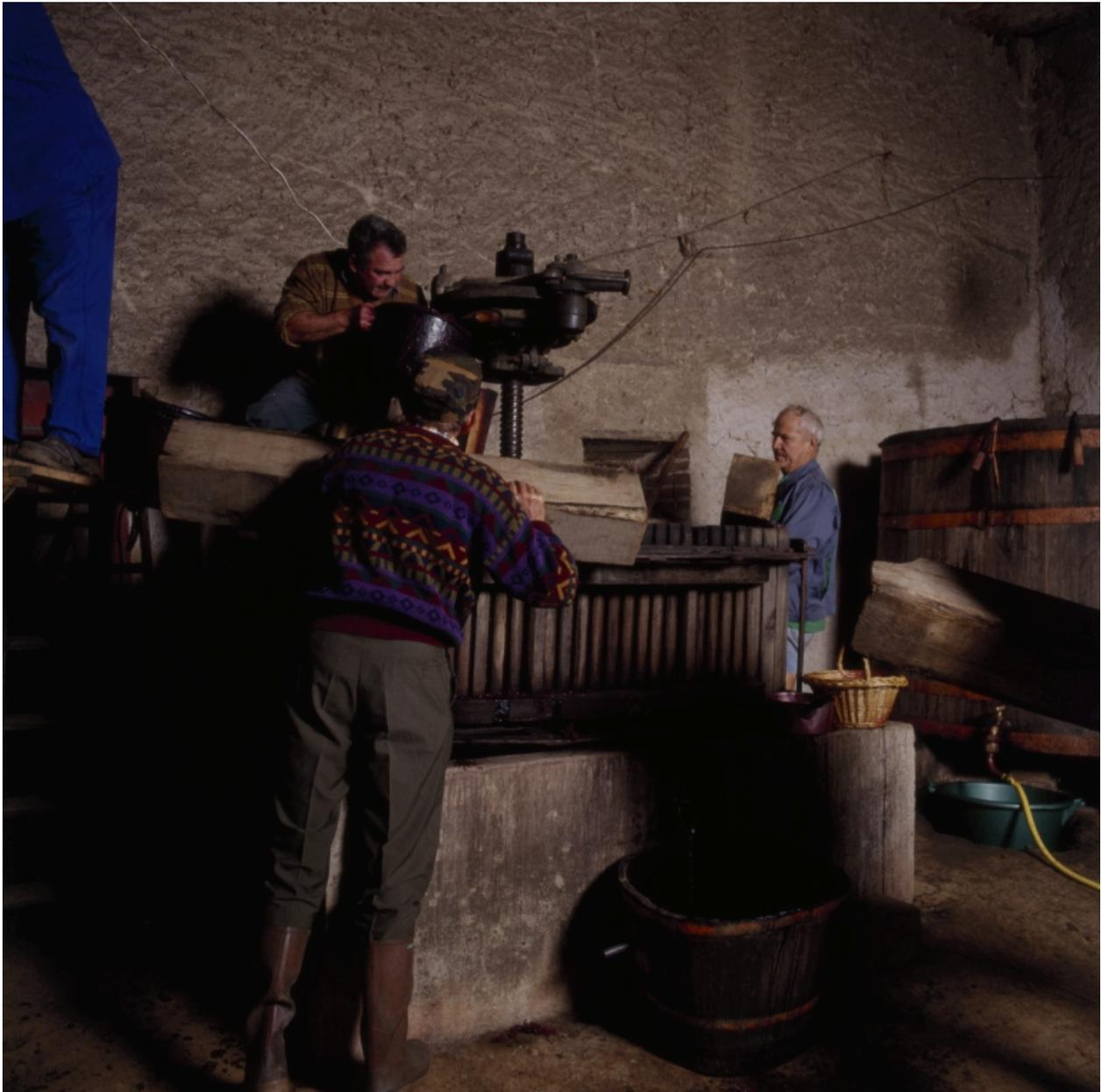
Cuvage à Champdieu (canton de Montbrison). Mise en place du mécanisme de presse.
