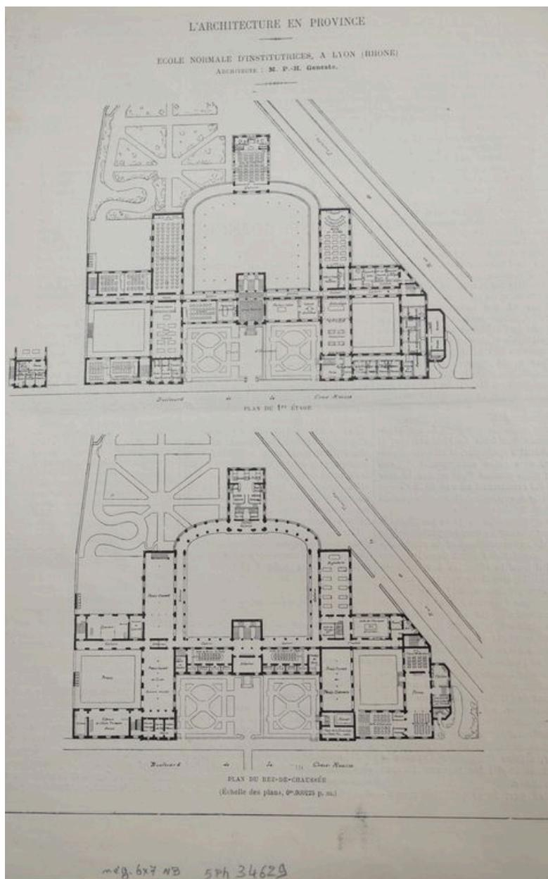
Plans de l'étage de soubassement, dit des préaux, et du rez-de-chaussée, dit étage des classes (Arch. mun. Lyon, 3 SAT 49, 'L'architecture en province [...]'. La Semaine des constructeurs, n°43, 14 avril 1894, p. 500-502).
