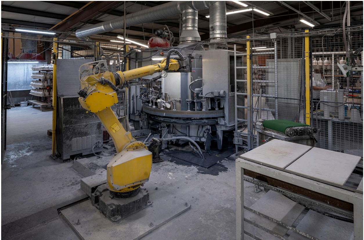
Emallage pulvérisation robotisée : usine de céramique culinaire "Revol porcelaine"
