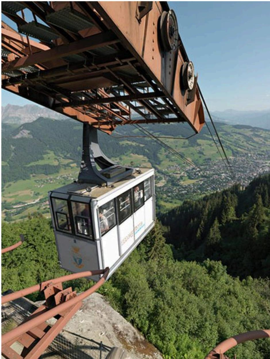
La cabine fabriquée par le carrossier Belle-Clos, suspendue au câble porteur, au départ de la gare supérieure.
