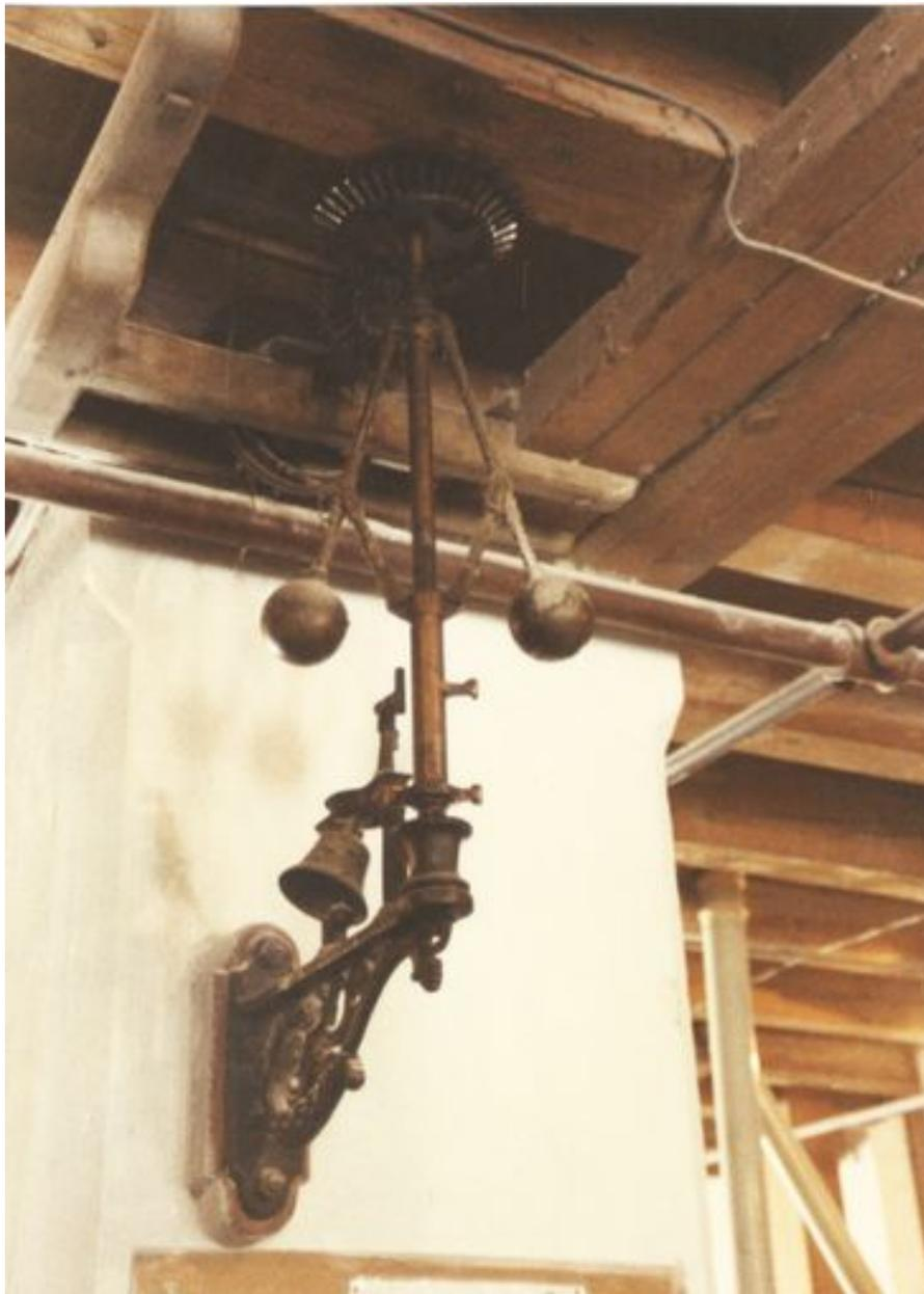
Détails de l'ancien système d'alarme du dispositif de régulation du bébit dans le canal d'amenée
