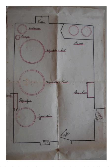
Devis d'installation de chauffage dans la salle de fabrication de la fruitière de Saint-Ours, vers 1930 (A. privées).
