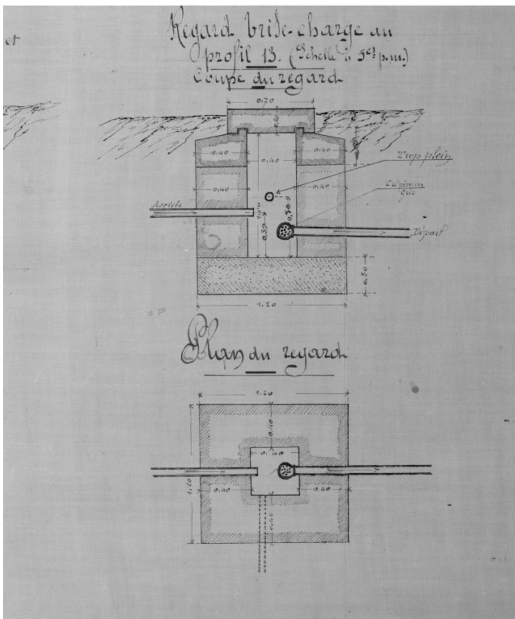
Plan et coupe d'un regard brise-charge au profil 13, par [Bertrand architecte, février 1904].
