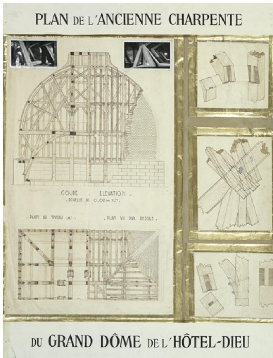
Ancienne charpente du grand dôme : panneau d'exposition composé de relevés (plans, coupe et détails d'assemblages) ainsi que de photographies [4e quart XXe siècle]
