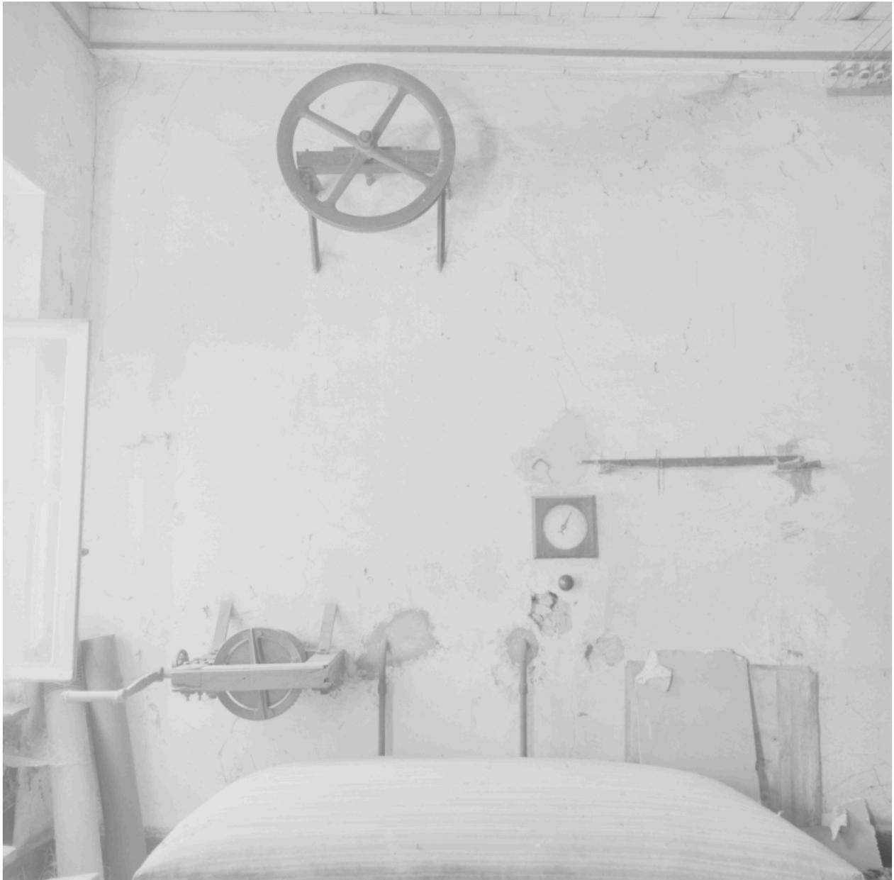
Manivelle, système de commande et essieu.
