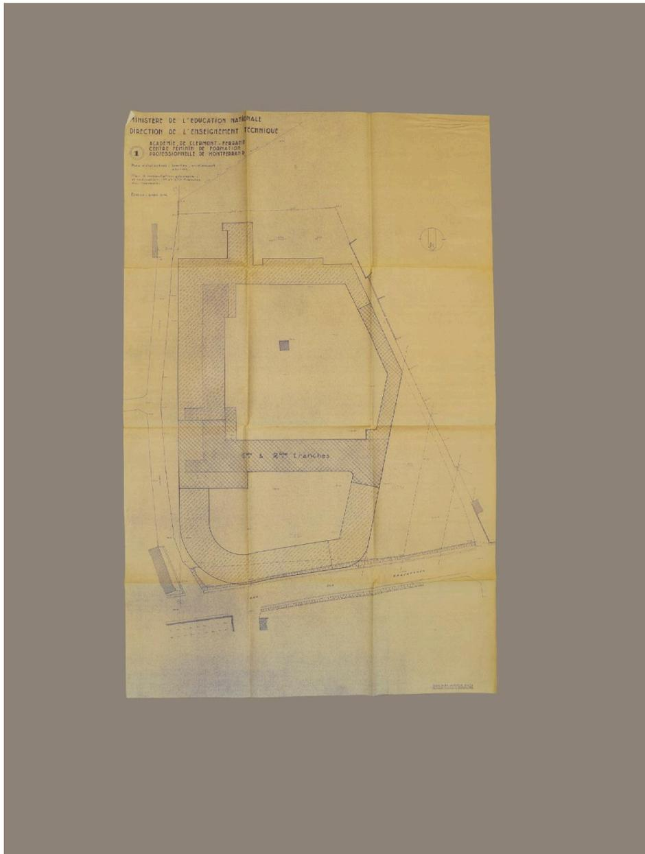
Plan d'état actuel : limites, nivellement, abords. Plan d'implantation générale et indication des 1<sup>ère</sup> et 2<sup>e</sup> tranches des travaux, par André Verdier, éch. 0,005 mpm, 12 mars 1951 (AC Clermont-Ferrand. PC n°028A 2310 28a)
