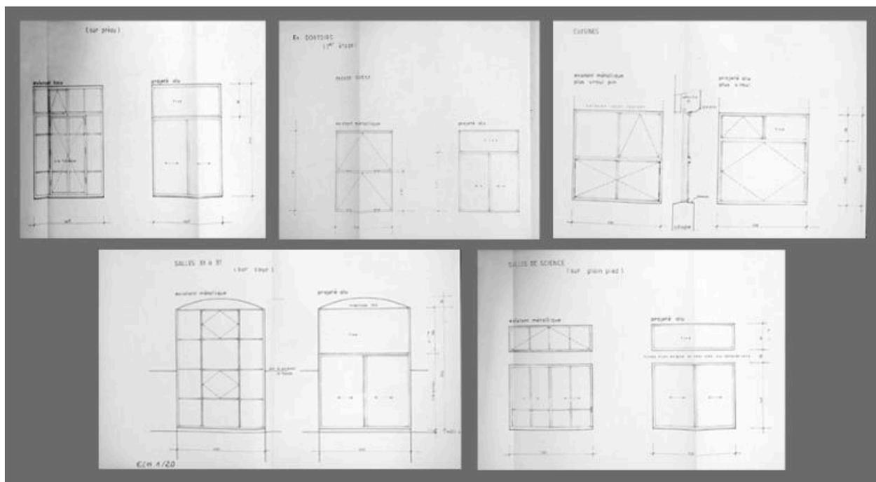
Châssis des fenêtres : état d'origine et schéma de principe des ouvrages retenus, 1983 (AD Ain, 1045 W 42)
