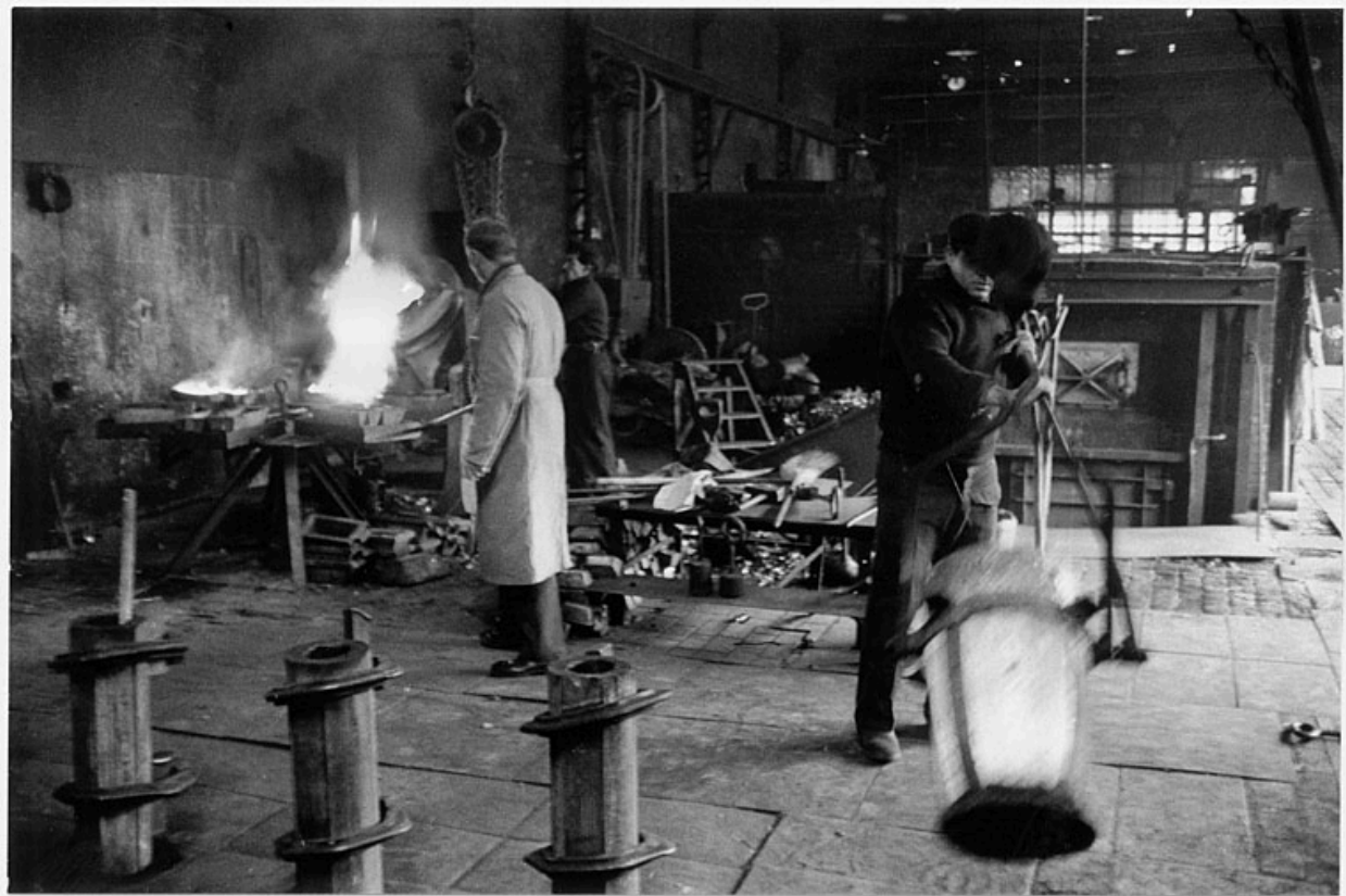
Sortie du creuset en fusion (phase 4)
