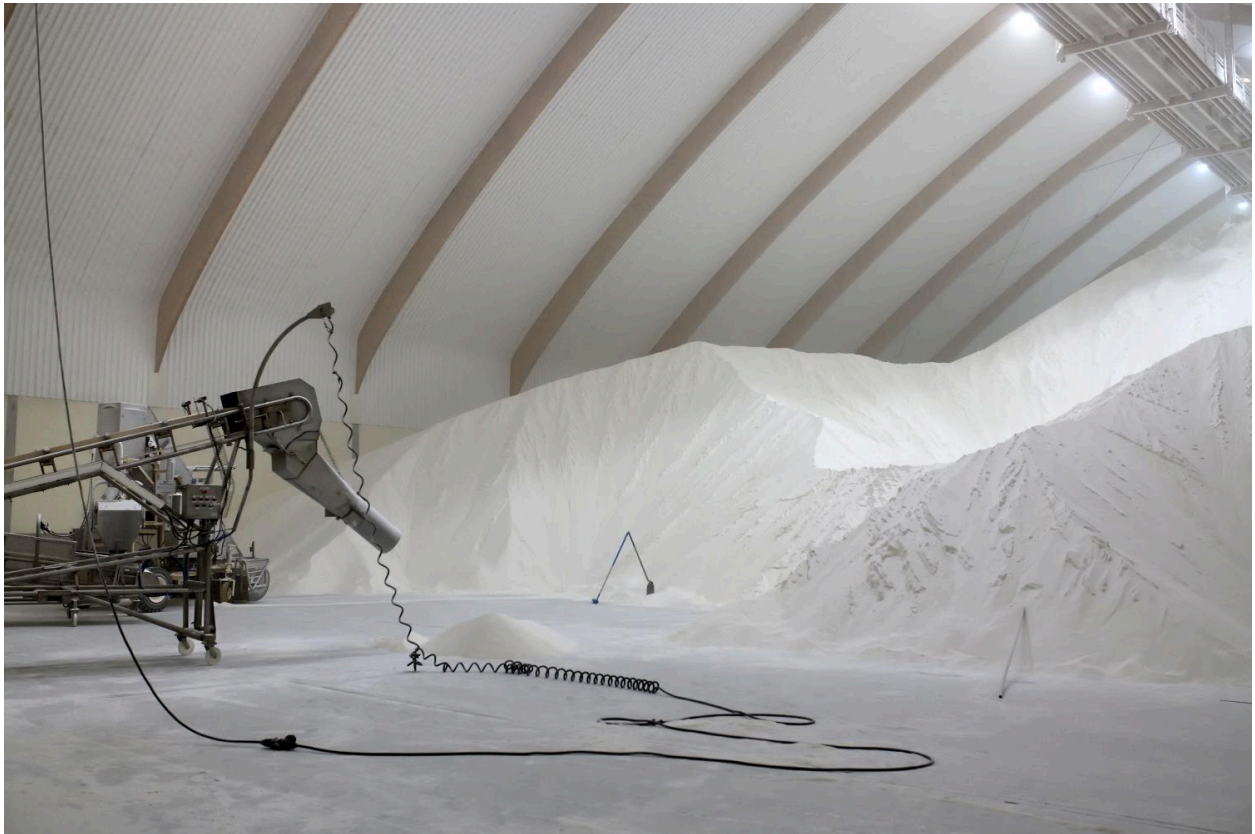
Collecteur-transporteur du sucre du silo (pour vider le silo)
