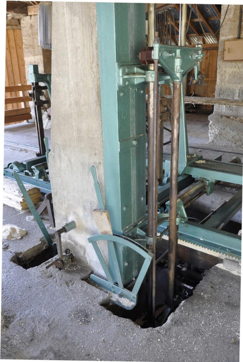
Détail d'un support et d'une commande du chariot.
