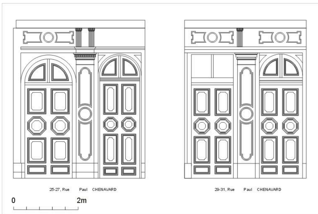
Elévation des façades sur la rue Paul-Chenavard, détail des portes, d'après un relevé photogrammétrique par A. Bensaci, 2003
