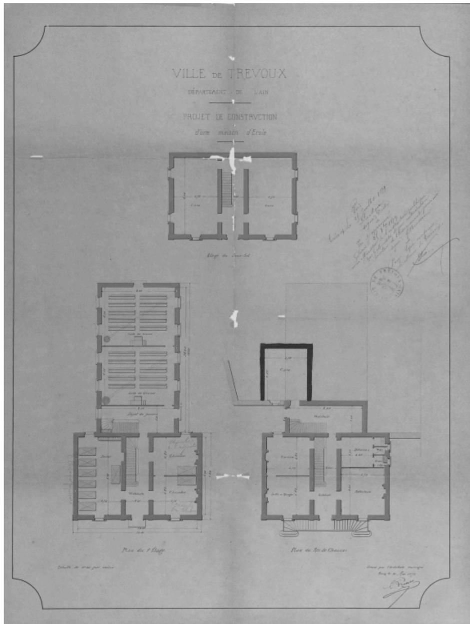
Ville de Trévoux... Projet de construction d'une maison d'Ecole. Plan du sous-sol. Plan du rez-de-chaussée. Plan de l'étage. C. Rochet, architecte, Bourg, 1879.
