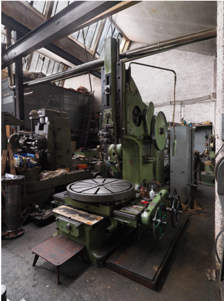
Machine Butler : mortaisage
