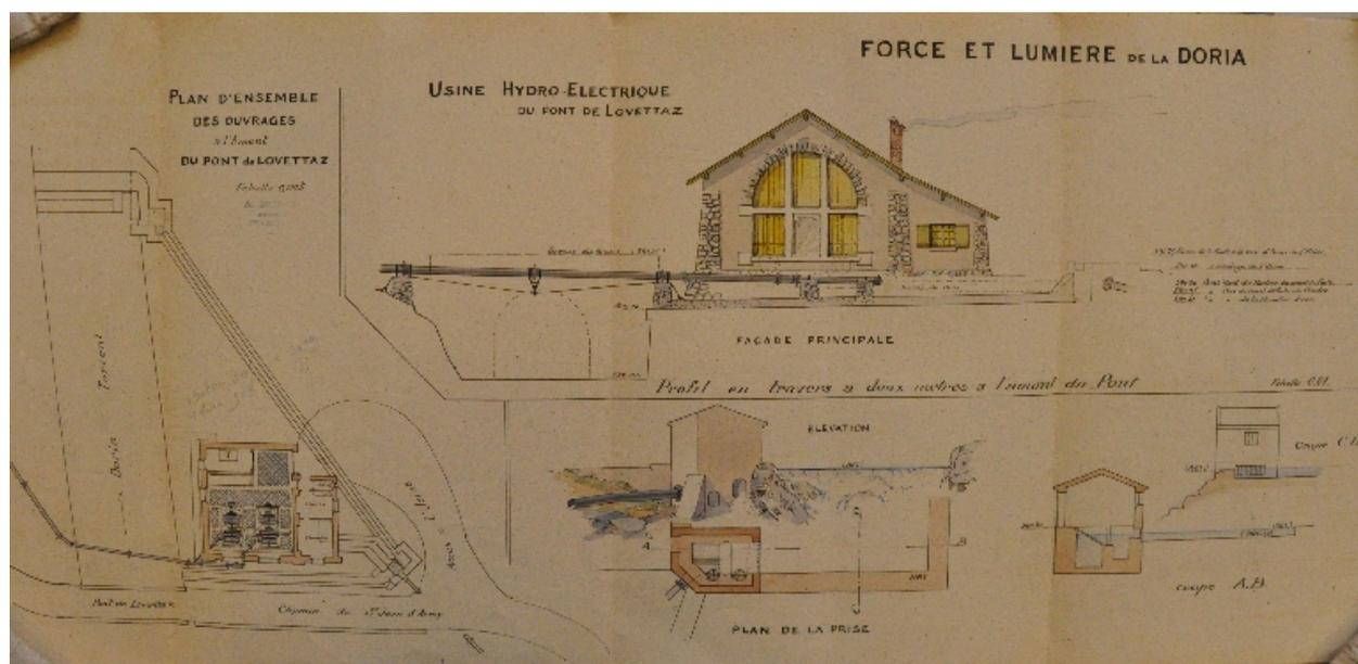
Plan des ouvrages à réaliser pour la centrale amont. Les travaux ne seront pas réalisés, 1921
